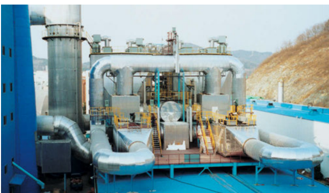
Dual-DeNO x -Katalysatoranlage für Glasschmelzwanne 304.600 m 3 /h
